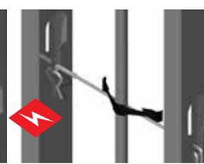
Fig 163 Adjustable Stud Spanner
